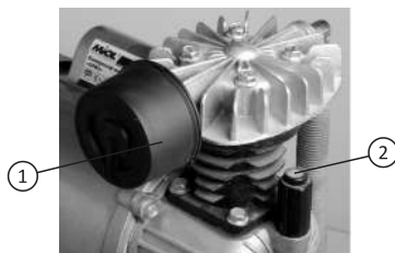
Рис. 3. Установка воздушного фильтра
