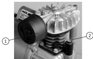
Мал. 3. Установка повітряного фільтра
